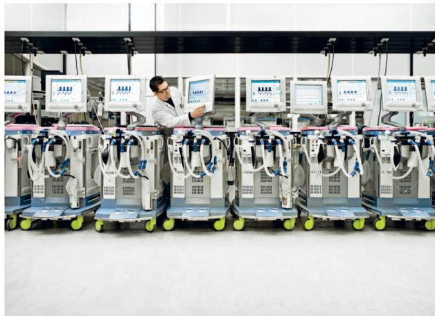
*Gerät neben Gerät: In einem speziellen Raum werden die Systeme einem Stresstest unterzogen.*
