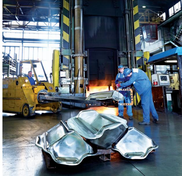
*Auf der 30.000-t-Gesenkschmiedepresse werden Schmiedeteile für das neue Großraumflugzeug A380 gepresst.*
