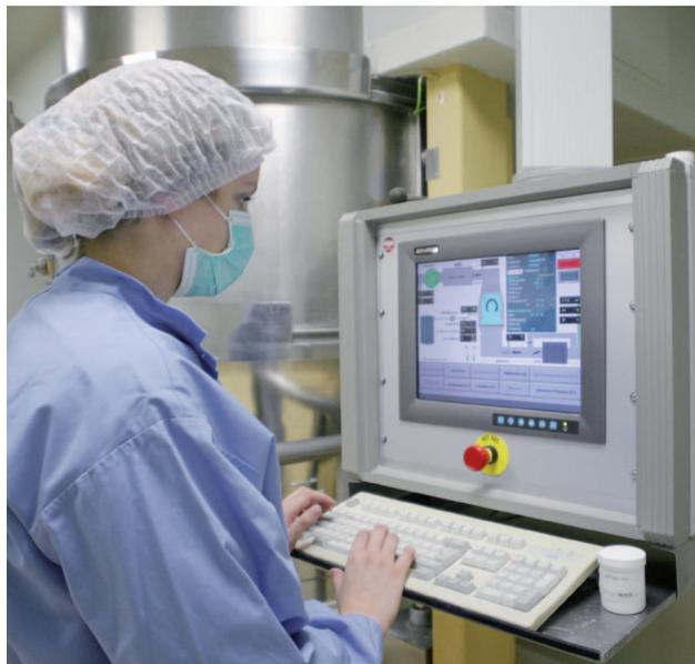
Programmierung des Granulierungsprozesses in der Feststoffproduktion.
