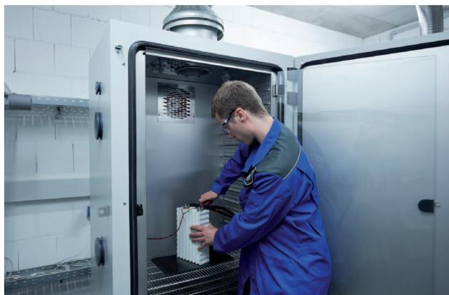
Vorbereitungen für einen Batterietest in einer Klimakammer bei der TÜV SÜD Battery Testing GmbH in Garching bei München.
