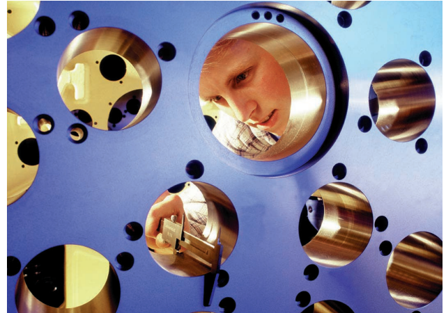
Den Durchblick behalten: Verteilerscheibe für Mehrspindel-Drehautomaten der „Baureihe PC“, gefertigt auf hochgenauen Produktionsmaschinen in der Eigenfertigung.
