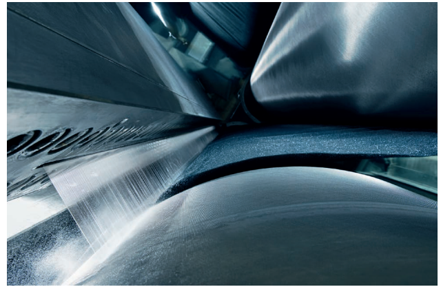
Eine von vielen Technologien in der Vliesstoffproduktion: die Wasserstrahlverfestigung
